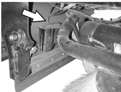
Slangetilkobling for undertrykksslange for senking av sidebørster
