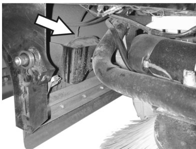
Slangetilslutning til undertryksdåsen af sidekostens sænkning
