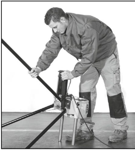
Fig. 1: RohrfüÙe einstecken Fig. 1: Inserting the tubular legs Fig. 1: Engager les pieds tubulaires Fig. 1: Infilare le gambe di supporto Fig. 1: Introducir las patas tubulares Fig. 1: Steunpoten insteken Fig. 1: Isättning av benen Fig. 1: Montering av rörben Fig. 1: Indstikning af rørben Kuva 1: Putkijalkojen asennus Fig. 1: Introduzir os pés tubulares Rys. 1: Montaż nóżek rurkowych Obr. 1: Trubkové nohy nastrčit Obr. 1: Růrkové nohy nastrčit 1. ábra: Feltolni a csőlábakat Sl. 1: Utaknuti noge od cijevi Slika 1: Vstavite cevno podnožje Fig. 1: Introducereea picioarelor tubulare Фиг. 1: Вставить трубные ножки Εικ. 1: Τοποθέτηση των σωληνωτών ποδιών Resim 1: Boru tipi ayakların takılması Фиг. 1: Постановяне на тръбните стойки 1 pav.: Vamzdinių kojų įstatymas Att. 1: Ievietot caurules galus Joonis 1: Torujalgade sissepanek
