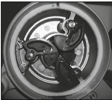
Fig. 4: Vorderes Spannfutter (19) Fig. 4: Front chuck (19) Fig. 4: Mandrin avant (19) Fig. 4: Mandrino anteriore (19) Fig. 4: Mandril de sujeción anterior (19) Fig. 4: Voorste spanklaauw (19) Fig. 4: Främre spännchuck (19) Fig. 4: Fremre spennchuck (19) Fig. 4: Forreste patron (19) Kuva 4: Etuistukka (19) Fig. 4: Mordentes de aperto anteriores (19) Rys. 4: Przedni uchwyt zaciskowy (19) Obr. 4: Přední sklíčidlo (19) Obr. 4: Predné sklíčovacíadlo (19) 4. ábra: Első tokmány (19) Sl. 4: Prednji stezni uložak (19) Slika 4: Sprednja vpenjalna glava (19) Fig. 4: Mandrina anterioară (19) Фиг. 4: Передний зажимный патрон (19) Εικ. 4: Μπροστινός σφιγκτήρας (19) Resim 4: Ön sıkıştırma mandreni (19) Фиг. 4: Преден универсал (19) 4 pav.: Priekinis kumštelinis griebtuvas (19) Att. 4: Priekšējā spīles ietvere (19) Joonis 4: Eesmine pingutuspadrun (19)
